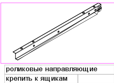
роликовые направляющие крепить к перегородкам
